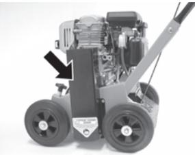
**Carter de protection pour la courroie :** Le carter de protection assure la protection des parties mobiles de l'entraînement et qui pourraient occasionner des blessures.
