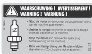
Cet autocollant est collé sur la machine, à hauteur du moteur. L'autocollant signale à l'opérateur d'arrêter le moteur et d'enlever le capuchon de bougie avant de commencer l'entretien de la machine.
