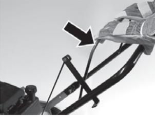
**Levier de commande :** Lorsque le levier de commande est relâché, l'entraînement des couteaux est déconnecté du moteur et l'axe des couteaux s'arrête de tourner.
