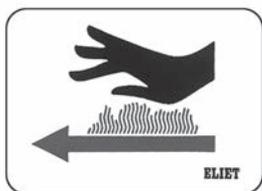
Cet autocollant est collé à proximité de la sortie d'échappement et prévient l'opérateur de la machine d'une surface chaude avec un réel risque de brûlures.
