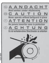
Cet autocollant est appliqué sur le carter de protection de la courroie d'entraînement. Il avertit du danger pour l'opérateur d'enlever le carter de protection alors que le moteur est en marche. Ne travaillez jamais sans ce carter de protection. Il est impératif de toujours couper le moteur pour enlever le carter de protection.
