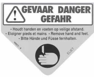
Cet autocollant est apposé sur le couvercle pour la commande et signale le risque de blessure des mains. On ne peut jamais placer les mains ou les pieds sous la machine lorsque les couteaux ne sont pas complètement arrêtés. Le moteur doit toujours être arrêté en cas d'irrégularités et surtout lors de l'entretien.
